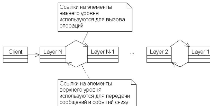
**Рисунок 11.** Пример структуры многоуровневой системы. Классы для уровней условные, они обычно декомпозируются на наборы более мелких компонентов.
