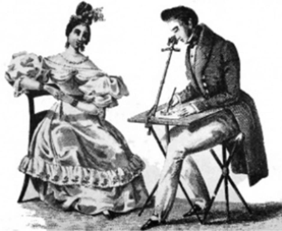
Camera Lucida — устройство, которое представляет собой конструкцию с призмой, которая крепится, например, на стойке к планшету.
