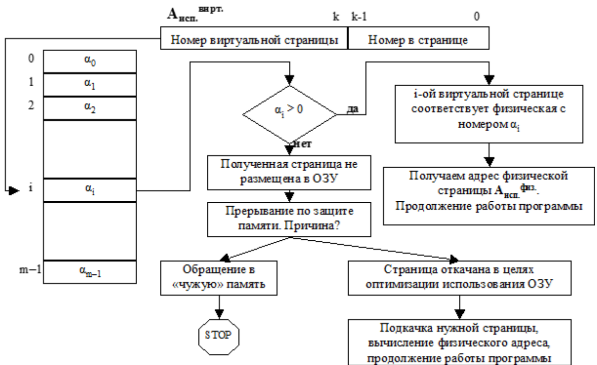
Рис. 58. Модельный пример организации страничной виртуальной памяти. Схема преобразования адресов.
