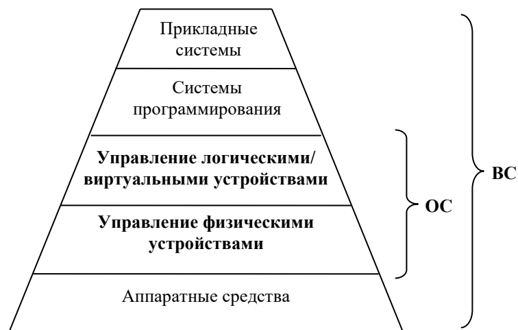
Рис. 4. Структура вычислительной системы.
