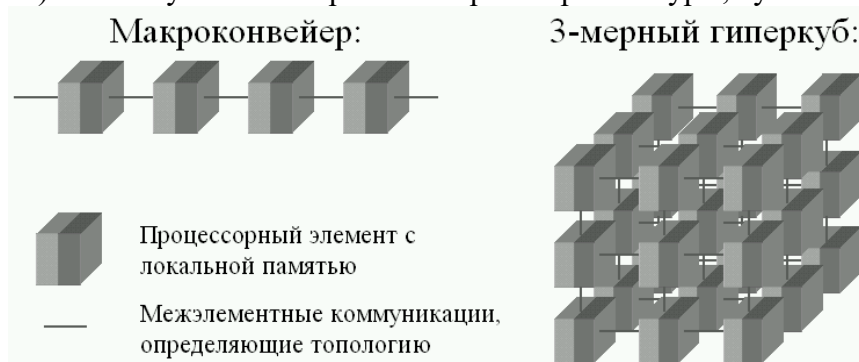
Рис. 62. Примеры топологий MPP-систем.
