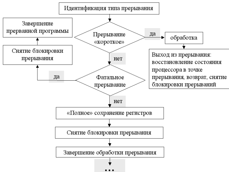
Рис. 33. Программный этап обработки прерываний.
