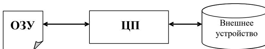
Рис. 40. Непосредственное управление внешними устройствами центральным процессором.
