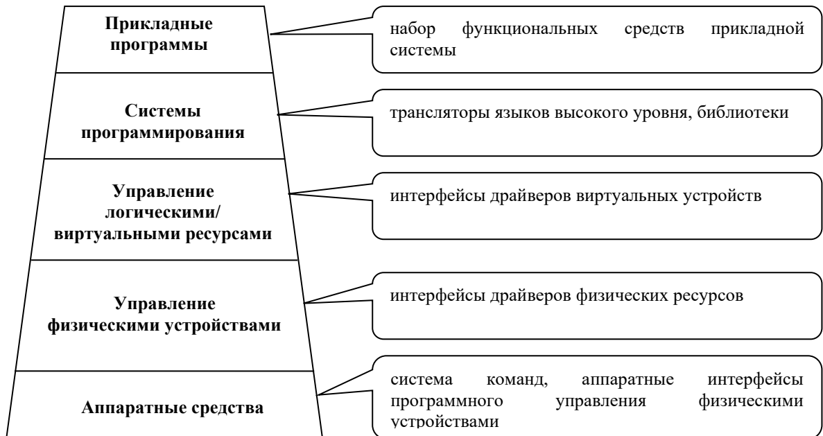
Рис. 19. Структура организации вычислительной системы.
