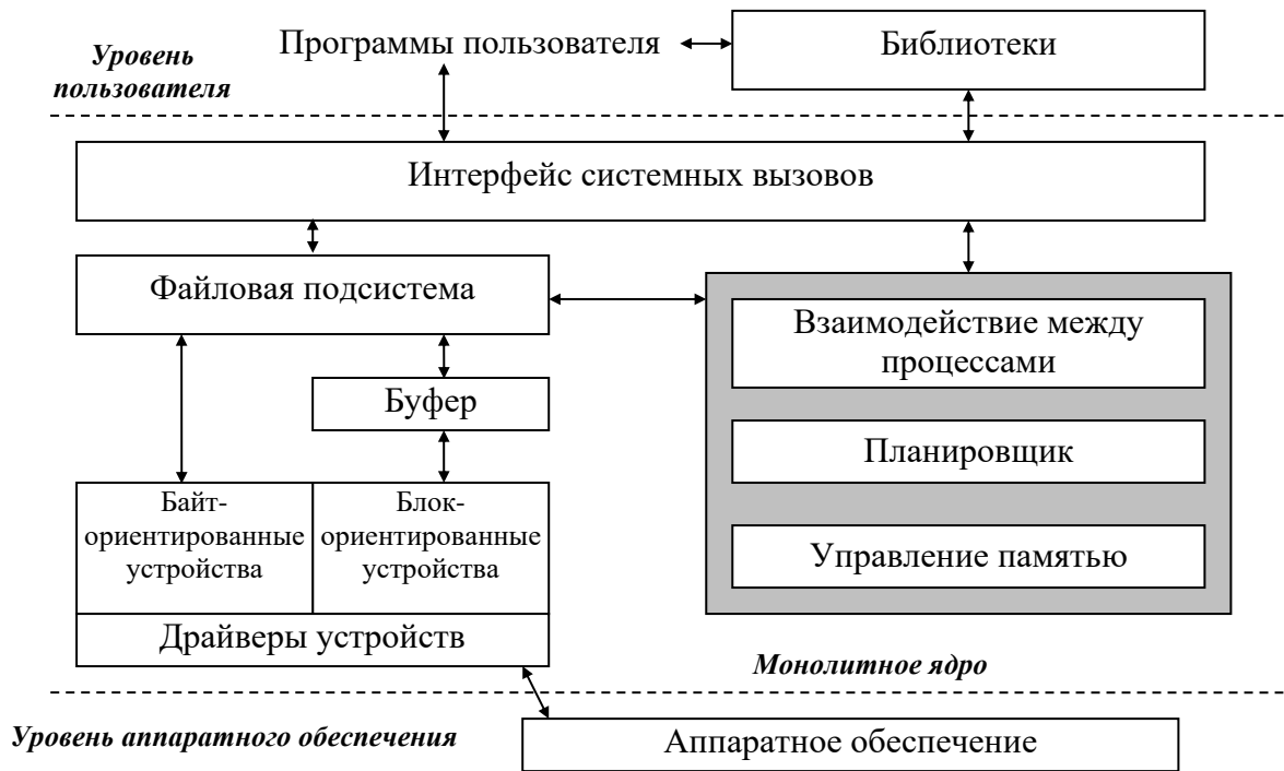
Рис. 73. Структура ОС с монолитным ядром.
